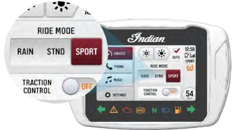
Se puede elegir entre tres modos de conducción: RAIN (lluvia), STD (estándar) o SPORT (deportivo), para tener una experiencia personalizada según su estilo de conducción. El mapa del acelerador de cada modo de conducción se ha diseñado pensando en una aplicación específica, lo que da como resultado una motocicleta con tres personalidades distintas.
