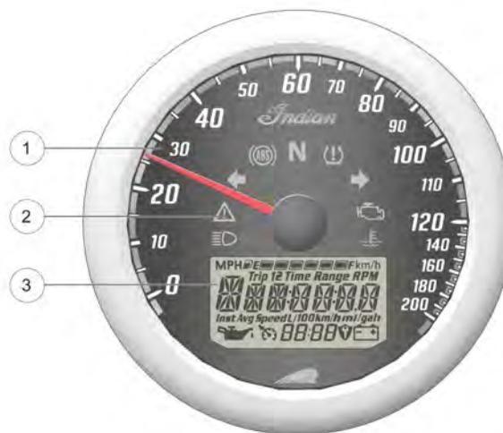
En el panel de instrumentos se incluye el velocímetro, las luces indicadoras y la pantalla de funciones múltiples (MFD).
