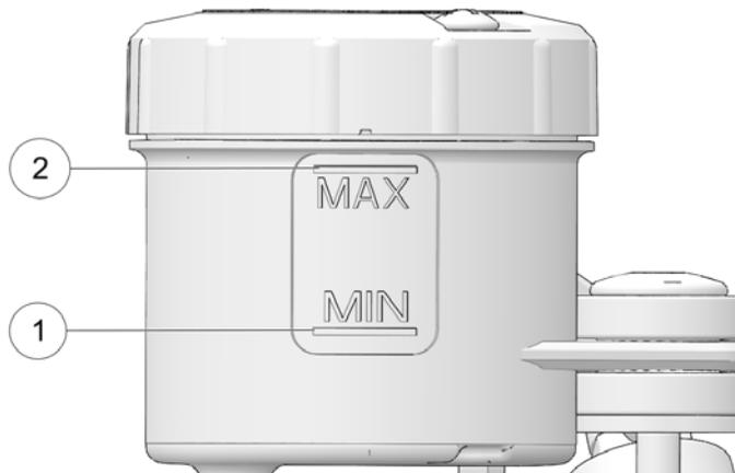
2. Compruebe el nivel del líquido del freno delantero a través del depósito de líquido. El líquido debe ser transparente y estar entre las marcas MÍN ① y MÁX ②. Si el nivel del líquido está bajo, inspeccione las pastillas de los frenos, tal como se indica en la página 141. Si las pastillas no están desgastadas más allá del límite de mantenimiento, inspeccione si el sistema de frenos tiene fugas.
